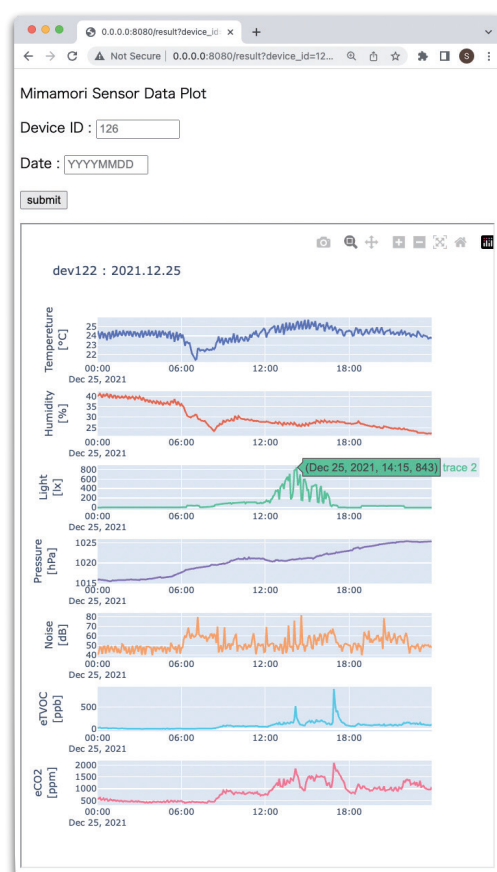
図3 Bottle と Plotly による測定結果のウェブ表示。2021年12月25日の例。
