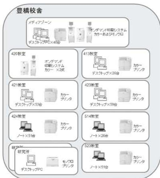
図25：クライアント構成（豊橋校舎）
